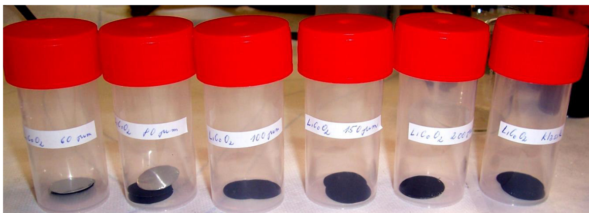
Obr.21: Elektrody nachystané k sestavení cely: vlevo vrstvy nanesené tyčí, vpravo nanesené klas. způsobem
