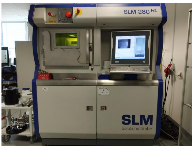
Obr. 2-5: Použitý stroj SLM 28 HL v laboratoři ÚK
