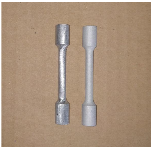
Obr. 4-9: Odjehlené (vlevo) a pískované (vpravo) těleso pro tahovou zkoušku
