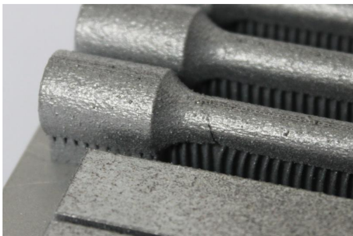
Obr. 3-1: Trhlina na zkušební tělese způsobená zbytkovou napjatostí
