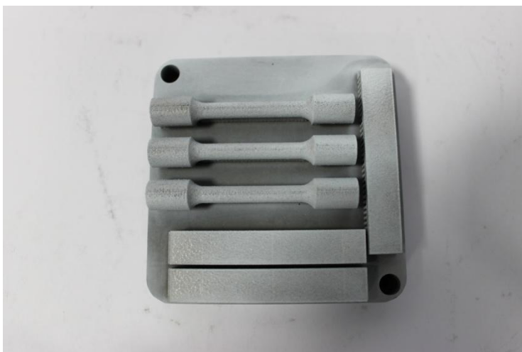
Obr. 4-2: Deska s horizontálními tahovými tělesy zmatněná pro skenování
