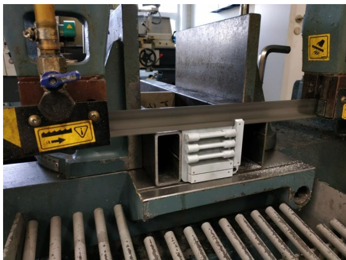
Obr. 4-8: Řezání zkušebních těles na pásové pile
