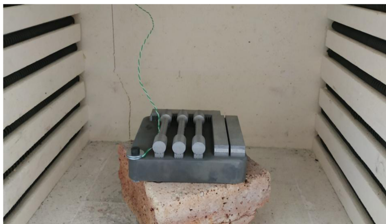
Obr. 4-6: Deska se zkušebními tělesy osazená termočlánkem uvnitř pece
