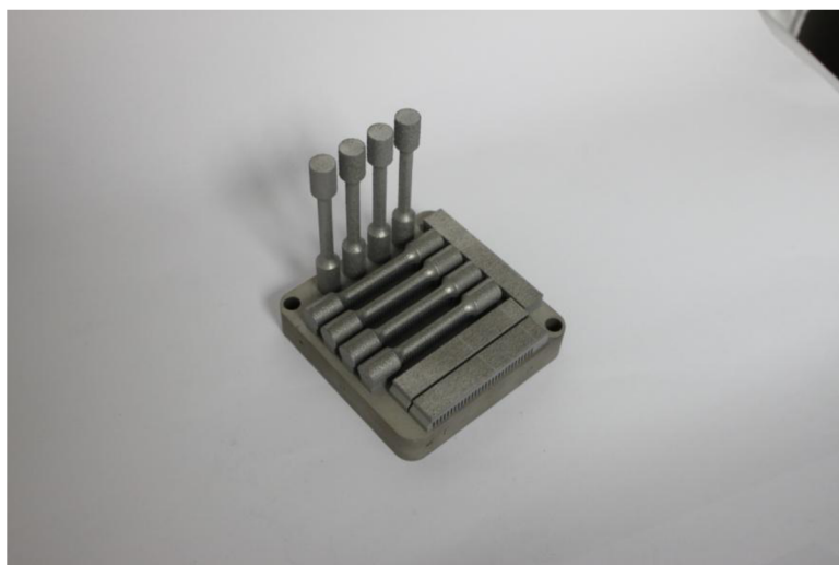
Obr. 4-3: Deska vertikálními tahovými tělesy po vyjmutí z SLM stroje
