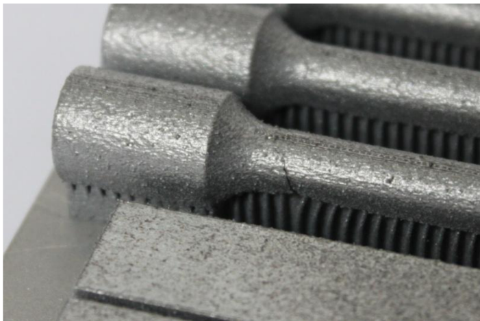
Obr. 3-1: Trhlina na zkušební tělese způsobená zbytkovou napjatostí
