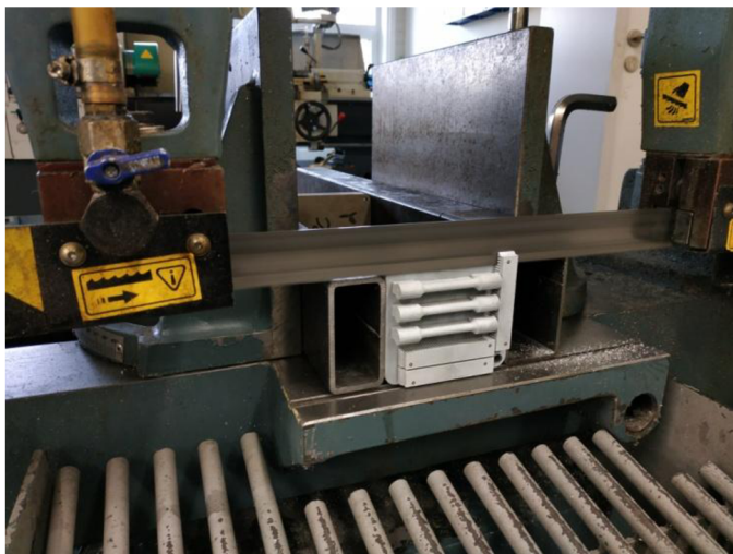
Obr. 4-8: Řezání zkušebních těles na pásové pile
