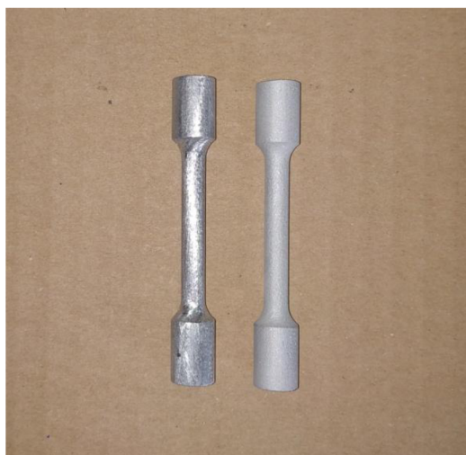
Obr. 4-9: Odjehlené (vlevo) a pískované (vpravo) těleso pro tahovou zkoušku
