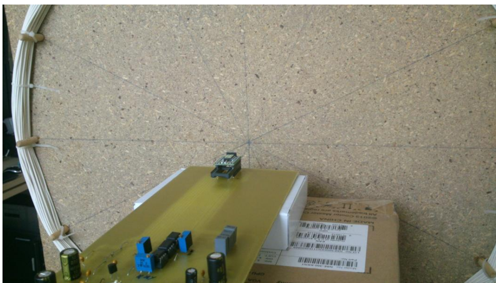
Obr. 3.12. Měření magnetického pole v ose X
