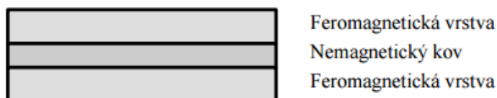
Obr. 2.7. Uspořádání vrstev GMR senzoru [11]
