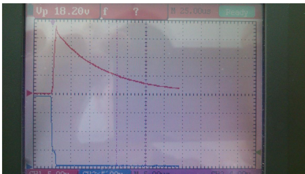
Obr. 3.10. První část resetovacího pulzu
