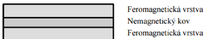
Obr. 2.7. Uspořádání vrstev GMR senzoru [11]
