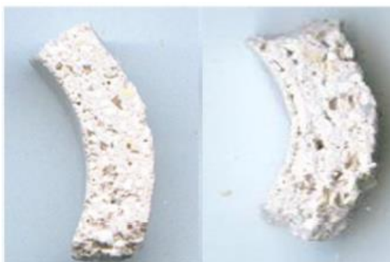
Obr. 37 Hrúbka škrupiny (a) bez pridaní pilín, (b) s pridaním pilín [53].
