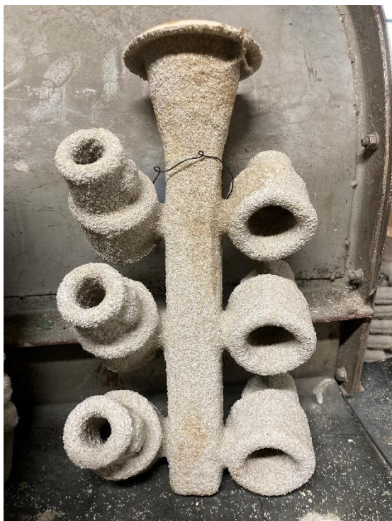
Obr. 53 Presiaknutý vosk na povrchu škrupiny.
