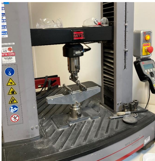
Obr. 56 Zariadenie na meranie MOR pri teplote okolia.
