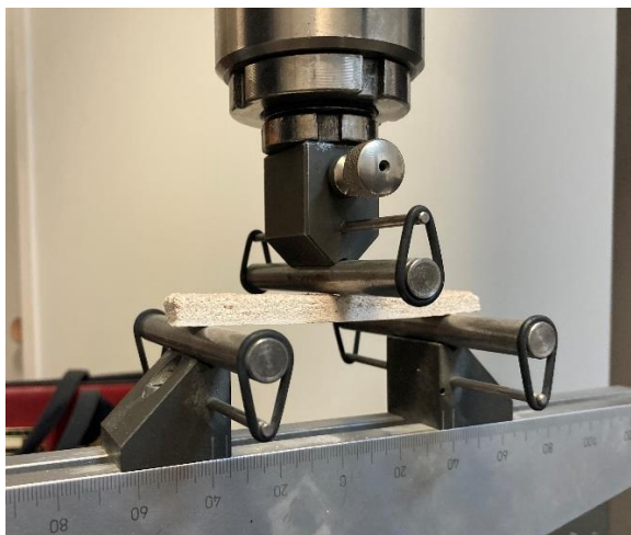
Obr. 58 Uloženie skúšobného vzorku do meracieho zariadenia pri teplote okolia.
