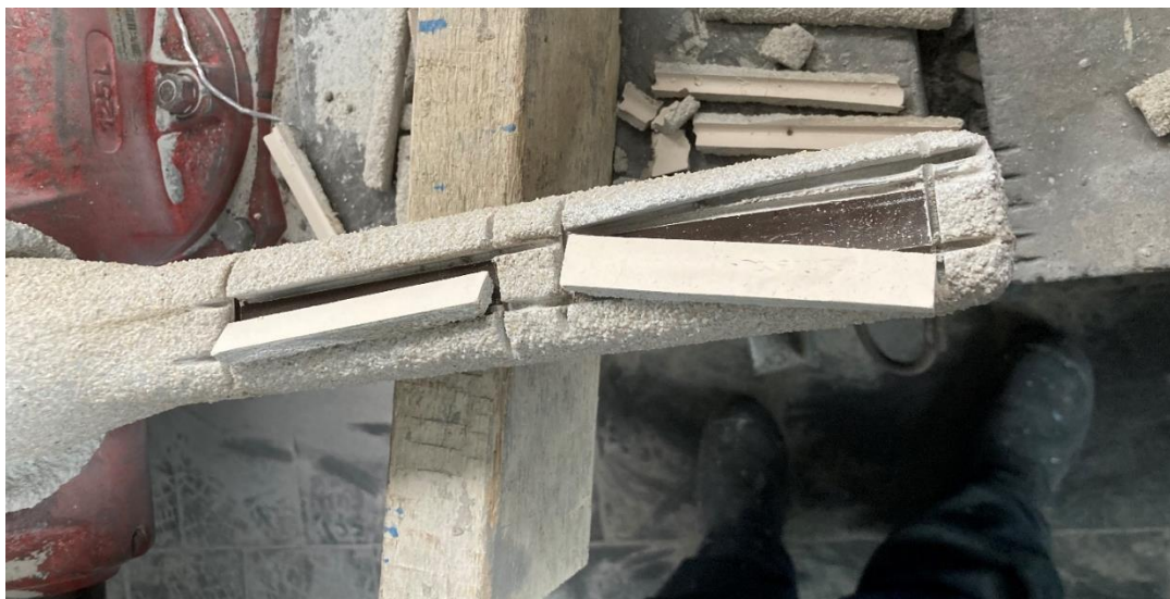
Obr. 55 Vyrezávanie vzorkov z obaleného vtokového kôlu..
