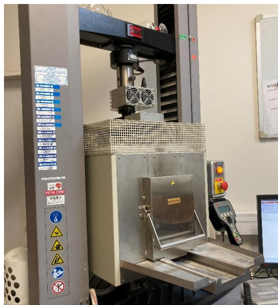
Obr. 57 Zariadenie na meranie MOR za zvýšených teplôt.
