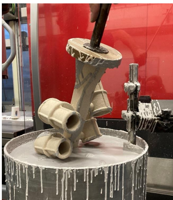
Obr. 50 Ponáranie modelovej zostavy v suspenzii.
