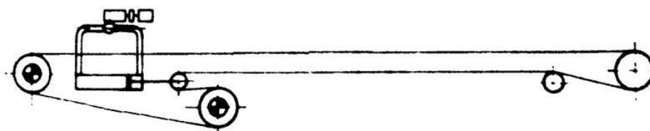
Obr. 1.4 Schéma elektrohydraulického napínání [2]
