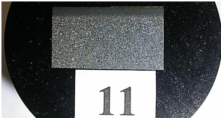
Obr. 72: Makroskopie vzorku č. 11 – technologie bez překryvu
