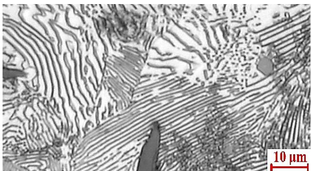
Obr. 27: Hodnocení obsahu perlitu a velikosti útvarů fosfidového eutektika (100x), leptáno
