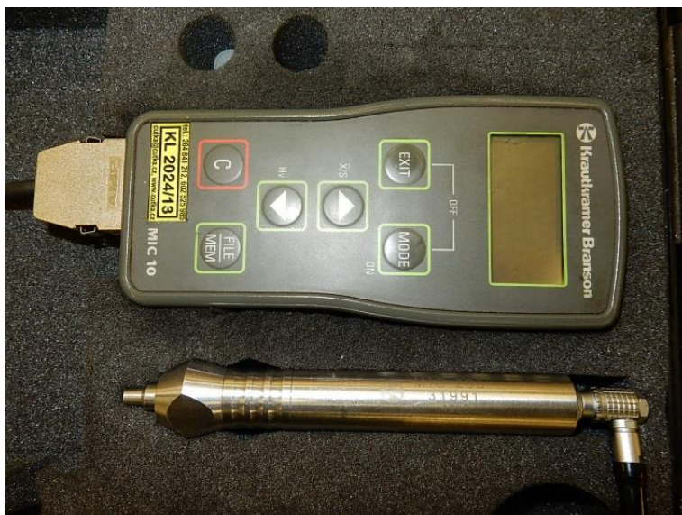
Obr. 21: Ultrazvukový tvrdoměr Krautkramer Branson MIC 10-34100
