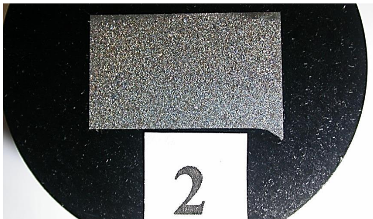
Obr. 36: Makroskopie vzorku č. 2 – technologie s překryvem
