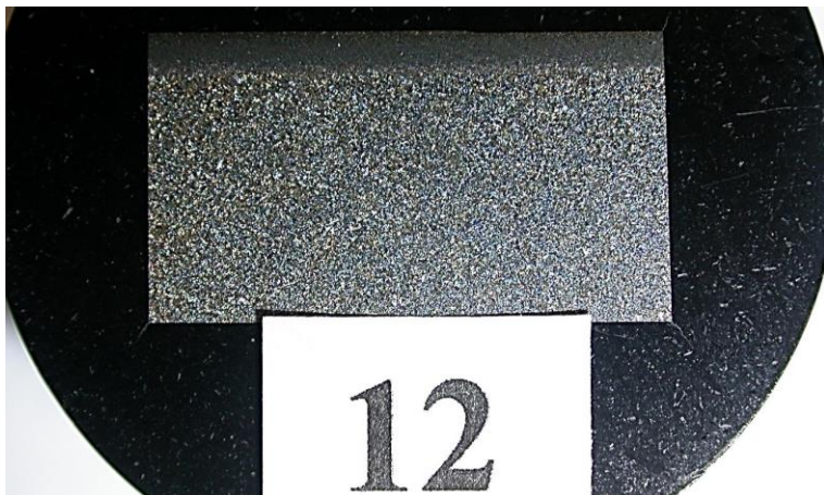
Obr. 76: Makroskopie vzorku č. 12 – technologie bez překryvu
