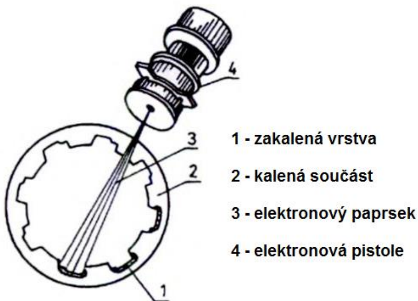
Obr. 9: Princip povrchového kalení elektronovým paprskem [1]
