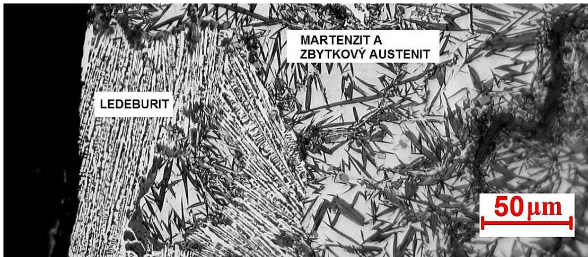
Obr. 41: Vzorek č. 3 – oblast 1 (200x)
