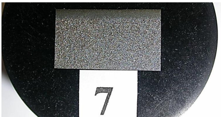
Obr. 56: Makroskopie vzorku č. 7 – technologie bez překryvu
