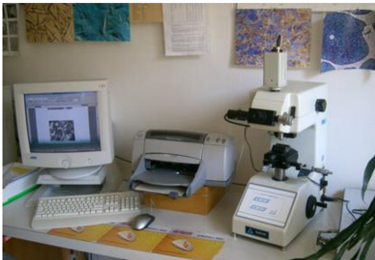
Obr. 80: Mikrotvrdoměr MICROMET 2100 Series (Buehler)
