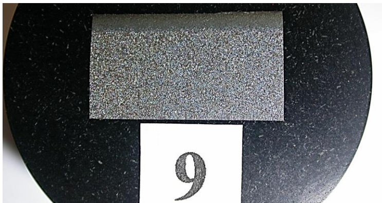
Obr. 64: Makroskopie vzorku č. 9 – technologie bez překryvu
