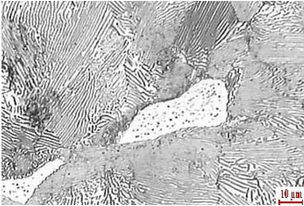
Obr. 29: Hodnocení tvaru perlitu a typu fosfidového eutektika (500x), leptáno
