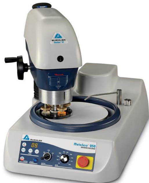
Obr. 25: Buehler bruska (leštička) MetaServ 250 s hlavou VECTOR LC 250 [28]
