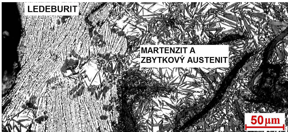
Obr. 49: Vzorek č. 5 – oblast 1 (200x)
