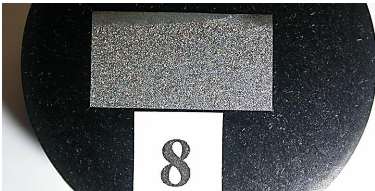
Obr. 60: Makroskopie vzorku č. 8 – technologie s překryvem
