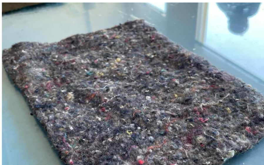
Obr. 32 Vrstva odsávací tkanina proti poškození při vakuování
