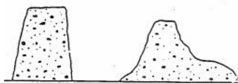
Obrázek 41: Tvary sednutí kužele (správné sednutí a usmýknuté sednutí) [2]
