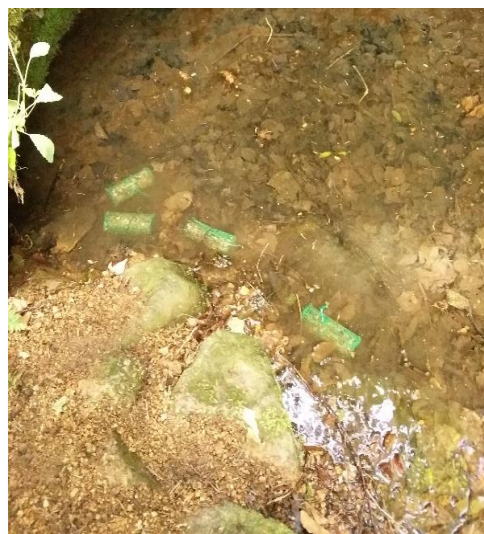
Obrázek č. 15 - uložené vzorkovače ve vývěru (Zdroj: vlastní fotografie)
