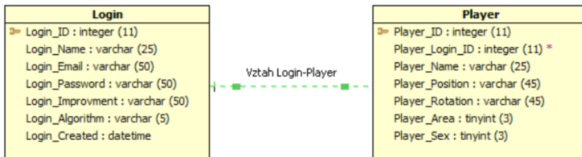
Obr. 12: ER diagram výsledné databáze
