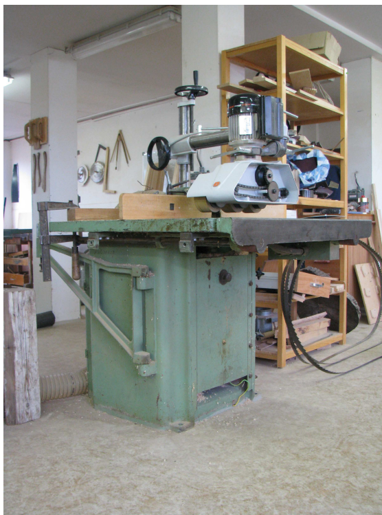
obr. 14 Pohled na spodní frézku s podávacím zařízením
