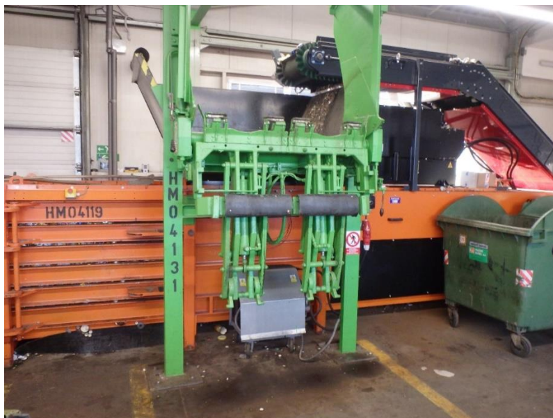
Obrázek 19: Lis, násypka a nakládač (Autor 2020)
