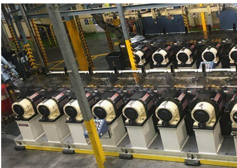
Obrázek 7: Tvarování hrdla a příruby (Ball Beverage Packaging Czech Republic s.r.o., dostupné z https://www.ballcorp.eu/plechovka/ )
