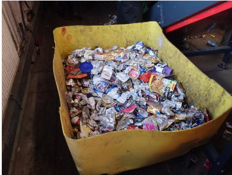
Obrázek 17: Přilepené nečistoty lehkých obalů (Autor 2020)
