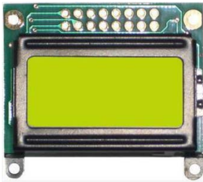
Obr. 8.2 Barevný alfanumerický displej MC0802A-SYL/H.
