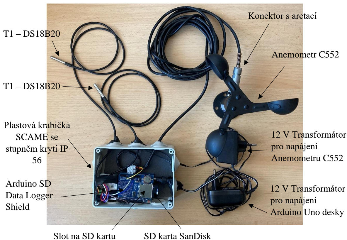
Obr. 7-2 Zapojení teplotních čidel DS18B20 a anemometru C552
