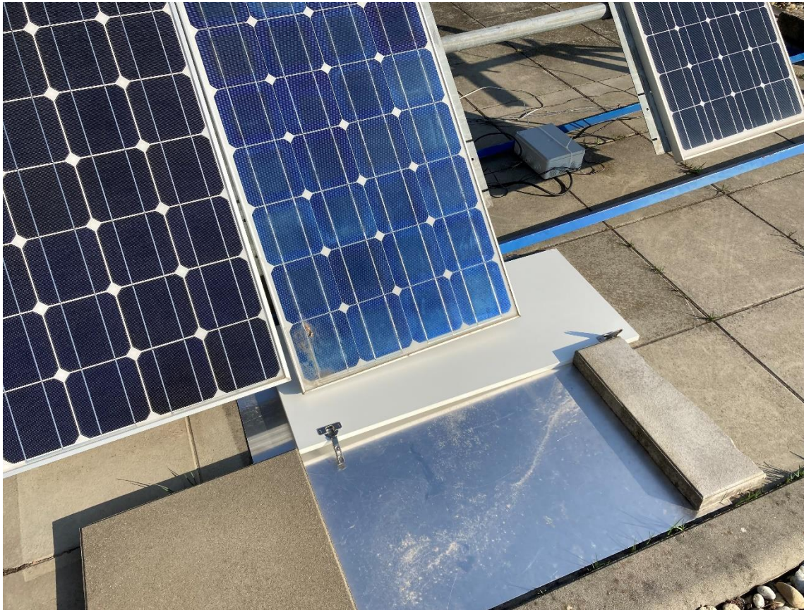
Obr. 8-23 Umístění bílé, dřevěné desky pod FV panel
