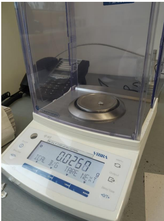
Foto č. 12: Navážení 25 mg vzorku v cínové kapsli (Rothbauer, 2022)
