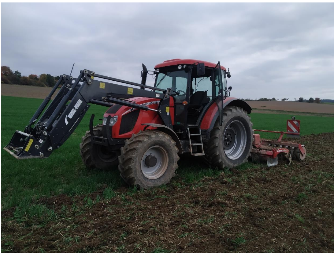
Foto č. 2: Zetor 140 HSX v agregaci s diskovým podmiťáčem Horsch Joker 3 CT (Rothbauer, 2022)
