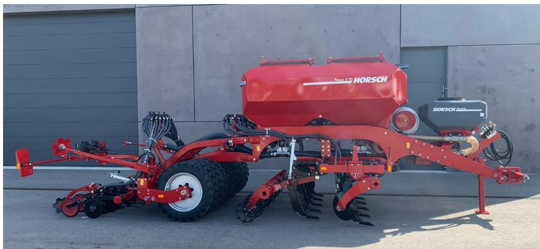
Obrázek 4: Secí stroj s diskovým výsevním ústrojím v kombinaci s hloubkovými kypřiči (Horsch, 2023)
