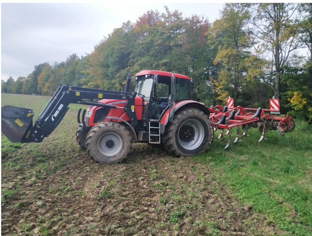
Foto č. 3: Zetor 140 HSX v agregaci s radličkovým kypřičem Horsch Terrano 3 FX (Rothbauer, 2022)
