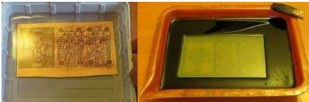
Obr. č. 50 Vyvolávání a leptání desky, převzato a upraveno z [14]
