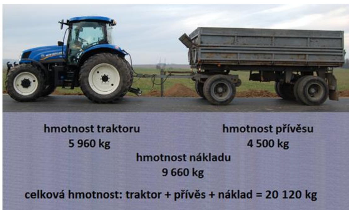
Obr. 18 Provozní hmotnosti měřené jízdní soupravy
