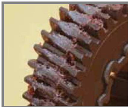
Obr. 4-1 Deformace zubu způsobená vysokou teplotou [3]
