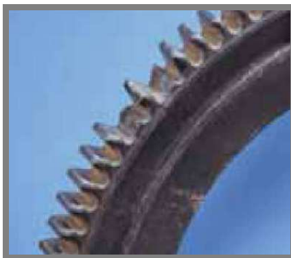
Obr. 4-2 Vylomení zubů způsobené přetížením [3]
