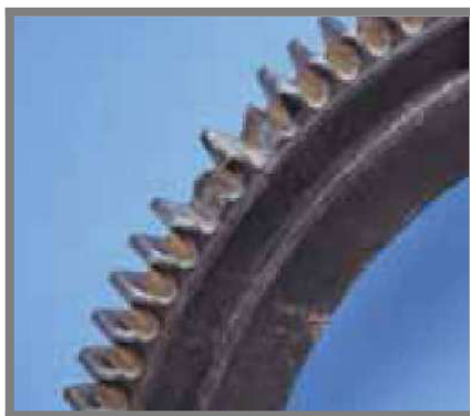
Obr. 4-2 Vylomení zubů způsobené přetížením [3]
