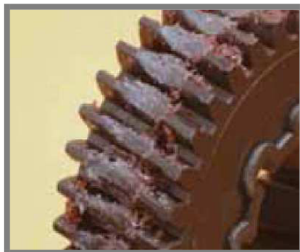
Obr. 4-1 Deformace zubu způsobená vysokou teplotou [3]
