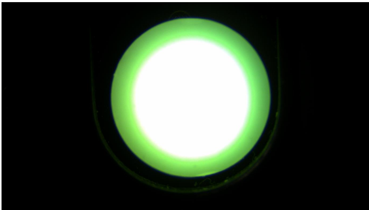
Obr. 5.8 Intenzita prošlého záření z osvětlovací diody na vzorku slinovaném při 1700 °C
