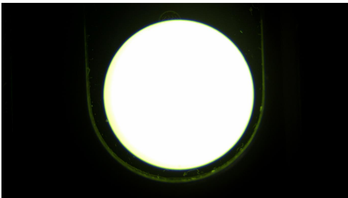
Obr. 5.9 Intenzita prošlého záření z osvětlovací diody na vzorku slinovaném při 1735 °C
