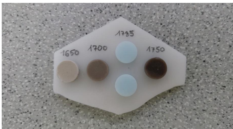
Obr. 5.6 Vzorky slinované ve vakuu, hnědé zabarvení v důsledku kyslíkových vakancí (vzorky slinované při 1735 °C jsou již přežíhané)
