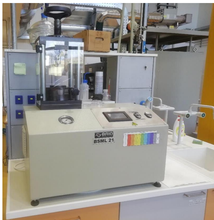
Obr. 4.5 Uniaxiální lis BSML 21
