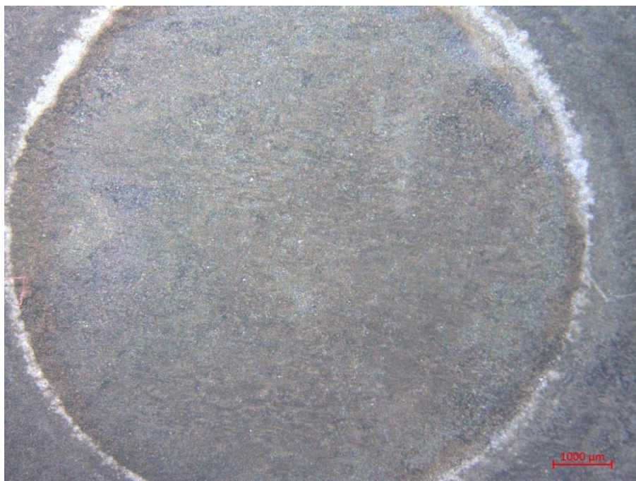
Obrázek 5.11: Napadená oblast povlakované slitiny bez známek koroze
