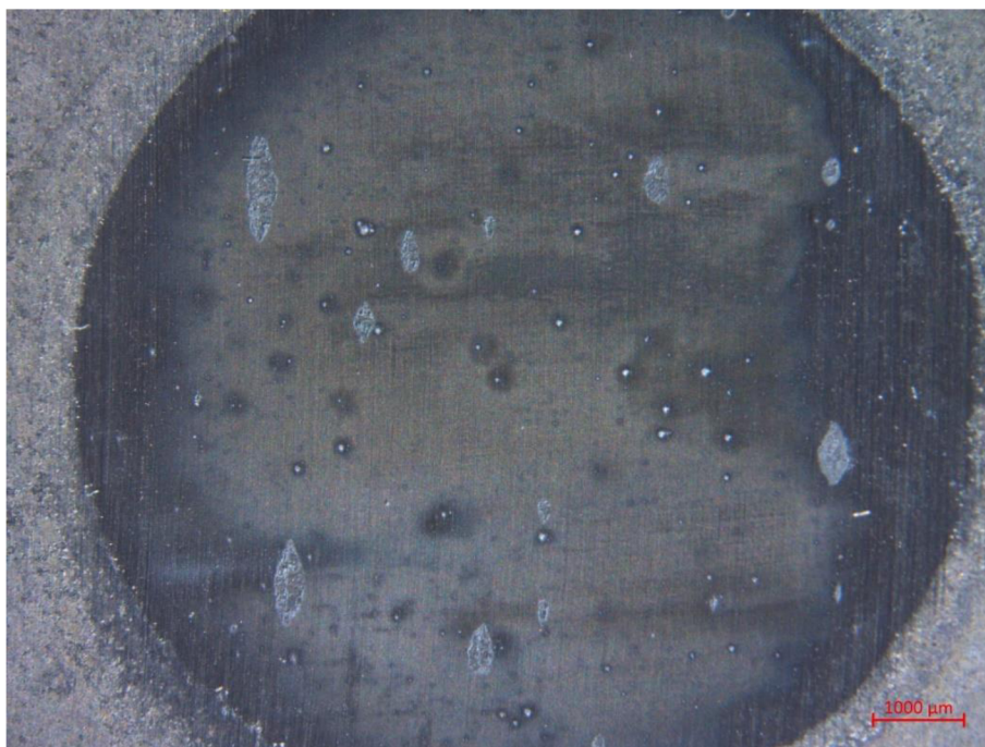
Obrázek 5.8: Napadená oblast s výraznými místy bodové koroze
