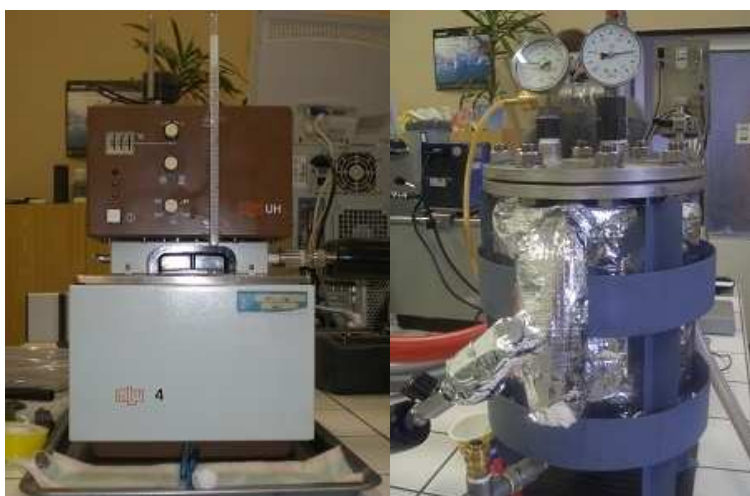
Obr. 21 Dezintegrace: termostát(vlevo) a tlaková nádoba(vpravo)
