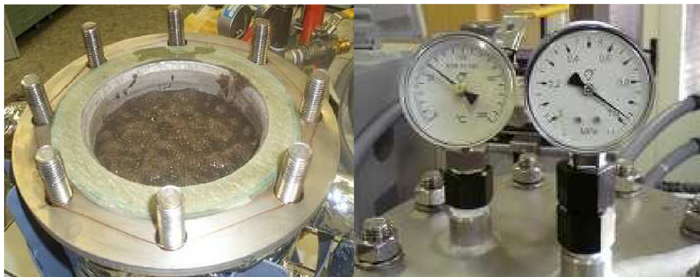
Obr. 20 Tlaková nádoba a kontrolky teploty a tlaku
