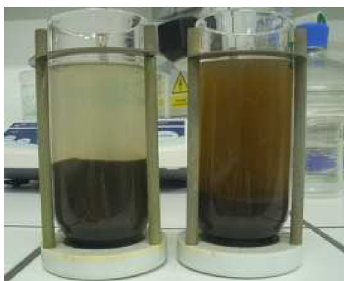
Obr. 23 Nedezintegrovaný (vlevo) a dezintegrovaný (vpravo) ZNK
