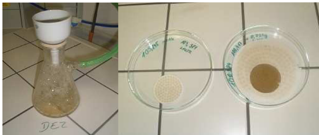
Obr. 24 Filtrace NL u dezintegrováného kalu a Petriho miska + filtrační papírky
