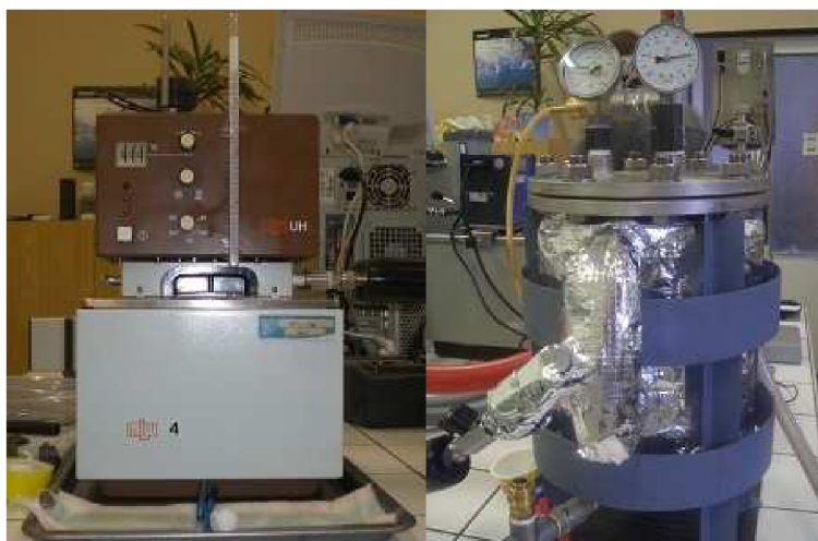
Obr. 21 Dezintegrace: termostat (vlevo) a tlaková nádoba (vpravo)
