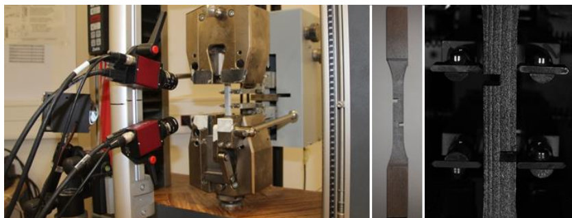
Obr. 4.3 Smyková zkouška tahem v LR a LT smykových rovinách. Kamerový set pro obrazový záznam přetvoření zkušebního tělesa (článek II).
