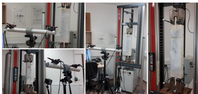
Obr. 4.4 Tahová zkouška únosnosti celodřevěného kolíkového spoje (článek III).
