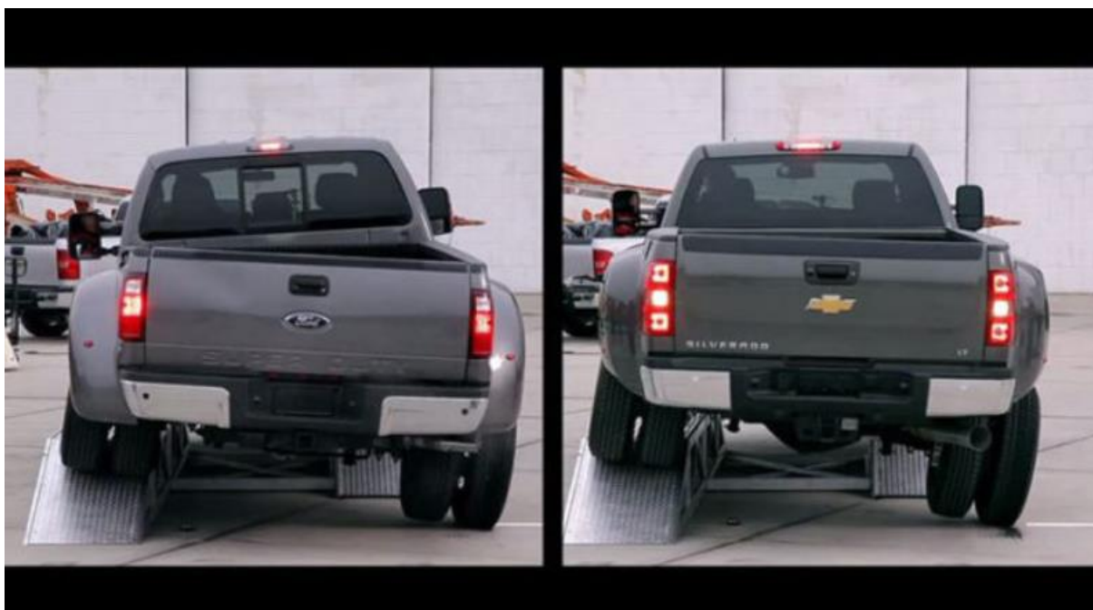
Obrázek 4: Porovnání rozdílných torzních tuhostí karoserií dvou vozidel [4]
