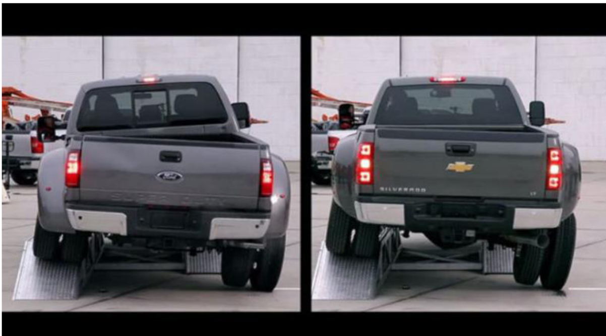
Obrázek 4: Porovnání rozdílných torzních tuhostí karoserií dvou vozidel [4]
