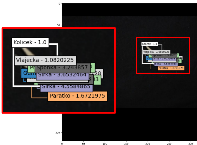
Obrázek 4.8 Predikce po krátkém testovacím učení. Bílý rámeček značí ground-truth, ostatní bounding boxy jsou predikce sítě. Confidence predikovaných bounding boxů jsou hodnoty před použitím funkce sigmoid.
