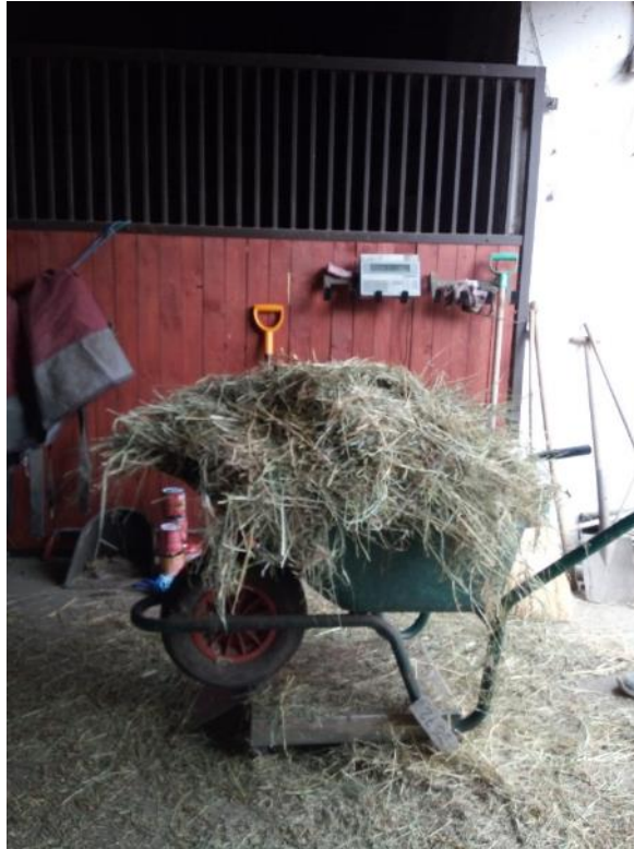
Obr.: 1. Váha s konstrukcí na míru plastovým kolečkům, které se ve stáji používají. Displej s ovládáním je umístěn na stěně boxu (Lucie Krejčová).
