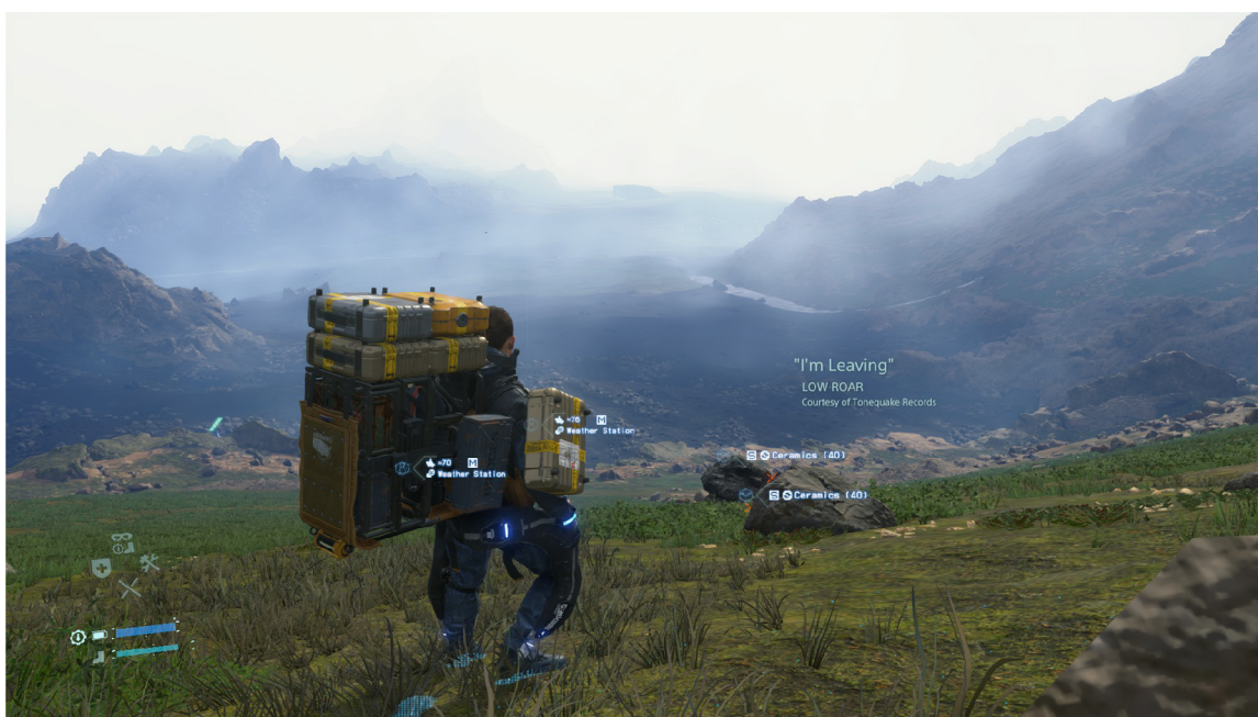
Obr. 2.24: Snímok obrazovky zachytený z hry Death Stranding na konzole PS4 Pro. Hra využíva textúrované quady pre zhluky trávy (možné vidieť v spodnej časti). Terén pokrýva výrazná trávová textúra.
