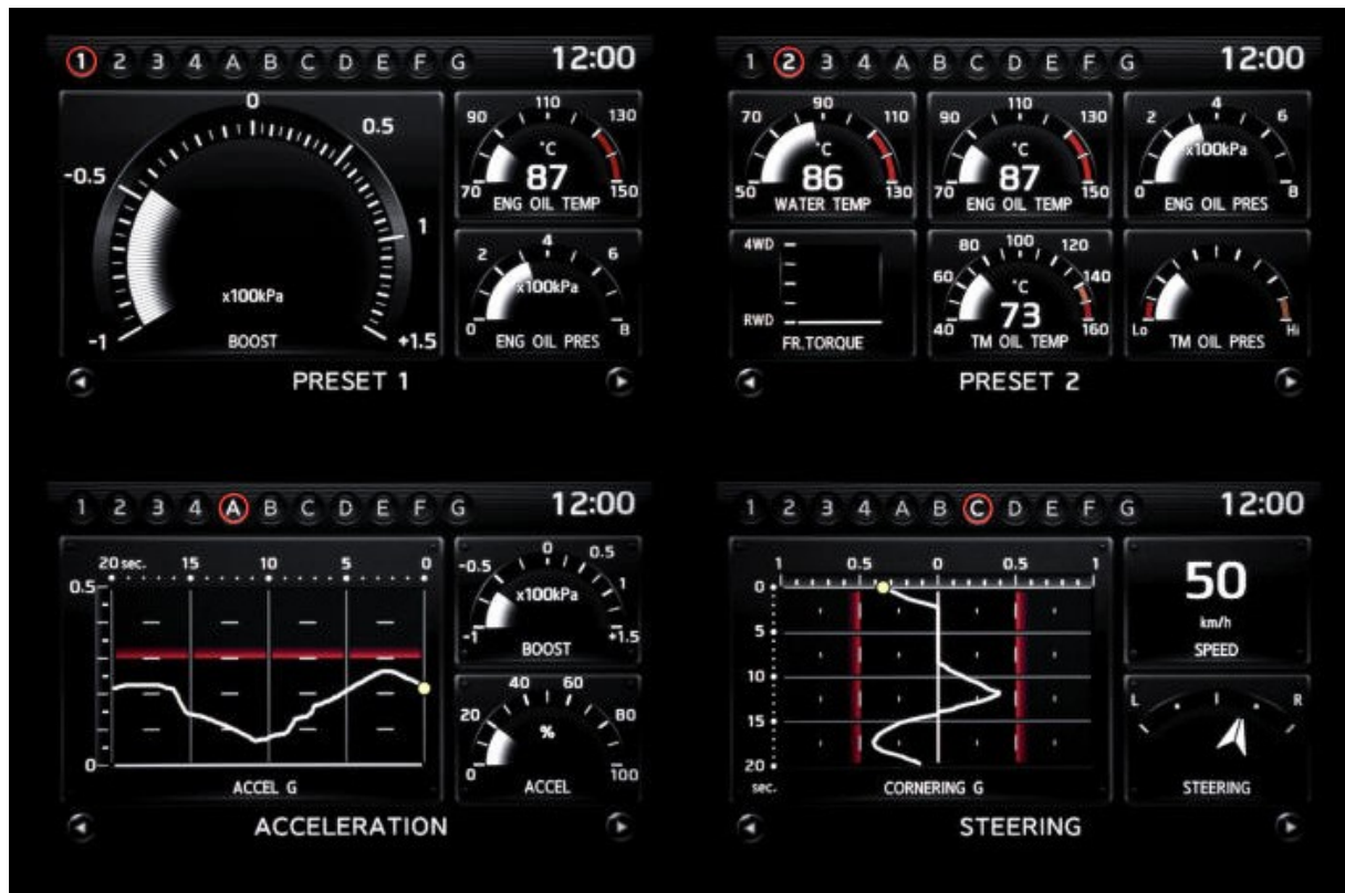
Obr. 2 – Ukázky výstupu z palubního počítače Nissanu GT-R [2]
