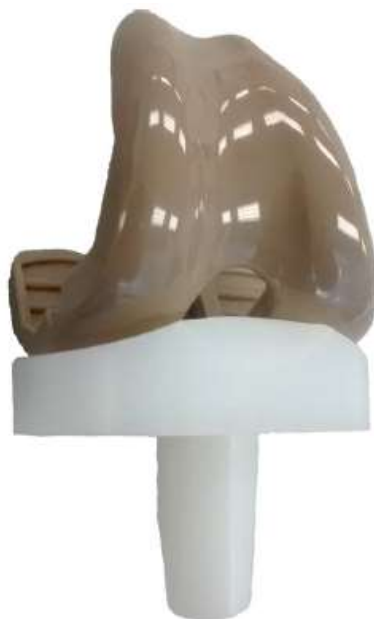
Obr. 6.2 PEEK femorální komponenta s UHMWPE tibiální komponentou [27]
