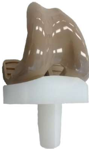
Obr. 6.2 PEEK femorální komponenta s UHMWPE tibiální komponentou [27]
