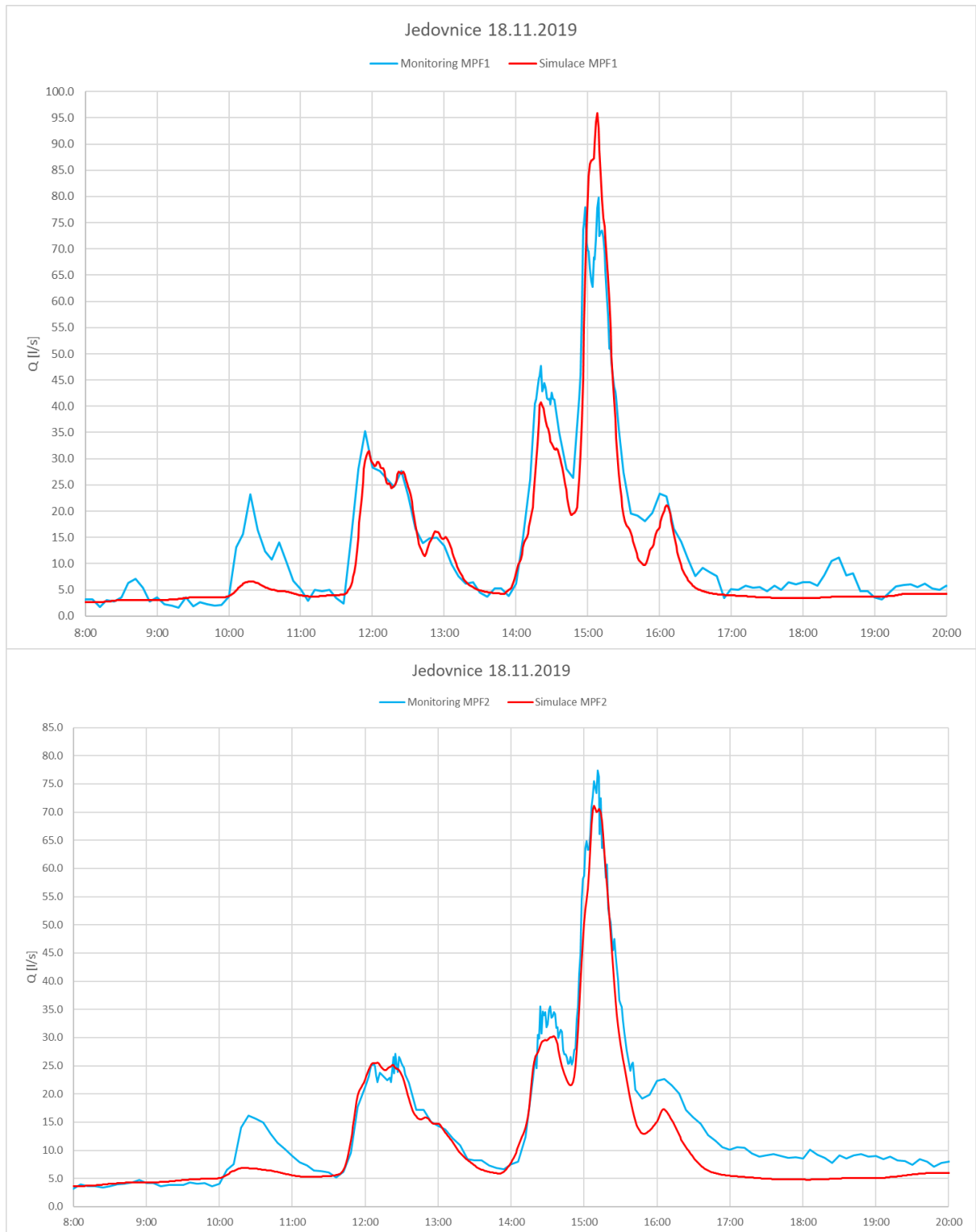
Obrázek 5.16 - Výsledek kalibrace měrných bodech MPF1 a MPF2 pro dešťovou událost ze dne 18.11.2019
