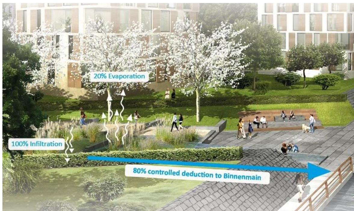
Obrázek 3.19 - Schéma HDV, maximální podpora vsakování, evapotranspirace a využití vody pro vodní prvky, přebytečná srážková voda je kontrolovaně odváděna do řeky Mohan [38]
