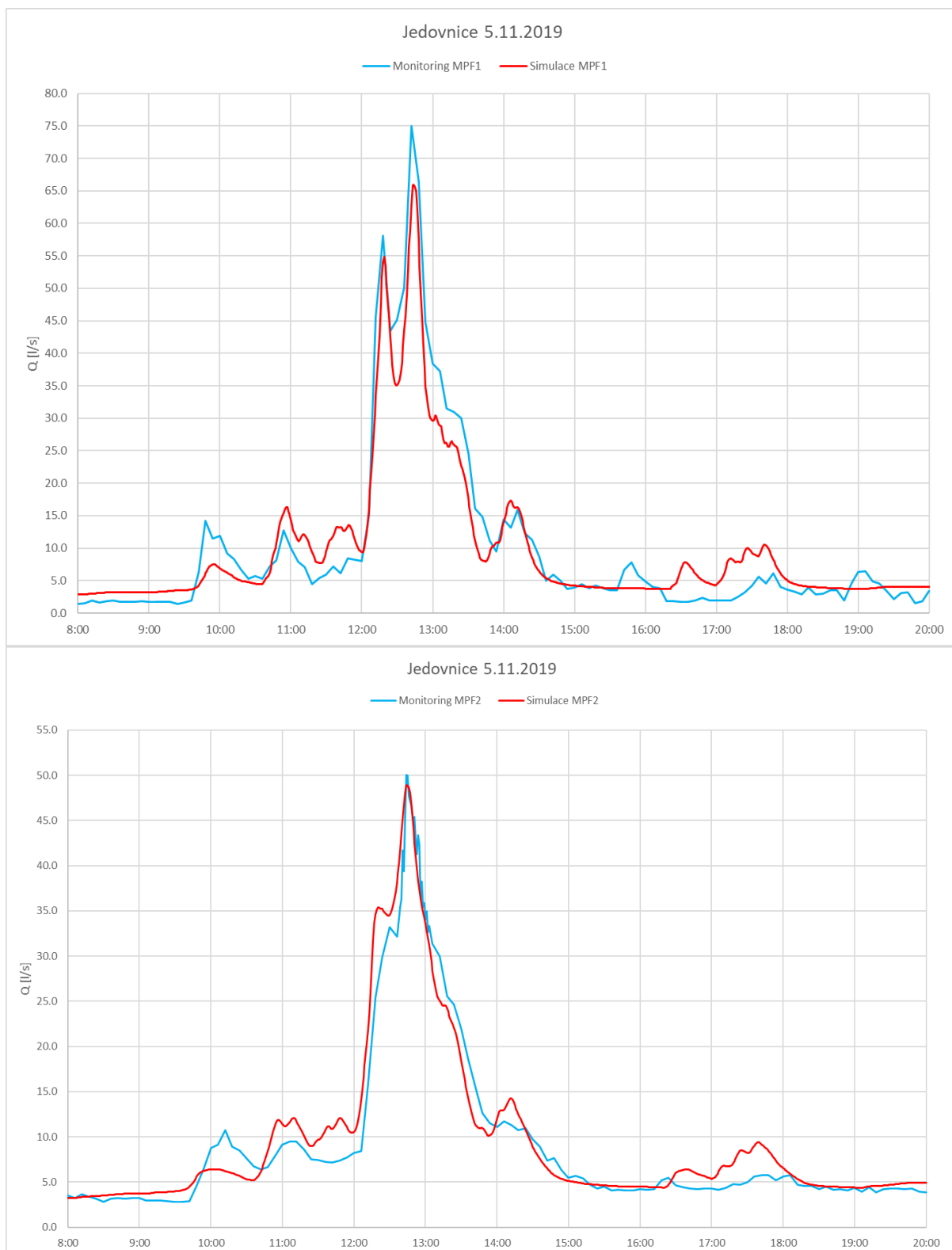
Obrázek 5.15 - Výsledek kalibrace v měrných bodech MPF1 a MPF2 pro dešťovou událost ze dne 5.11.2019
