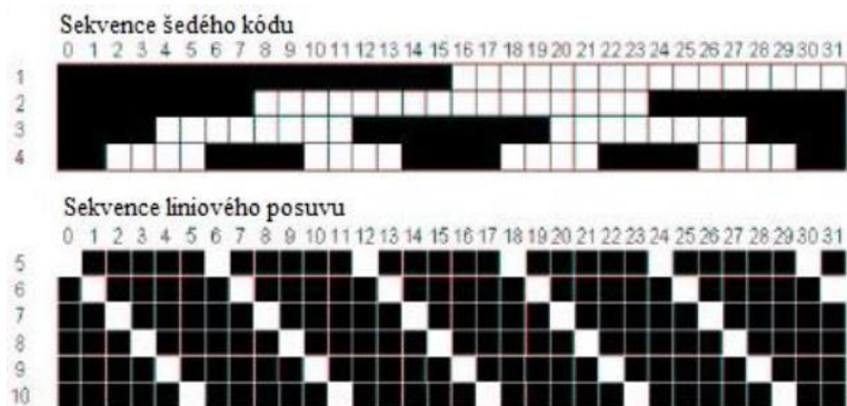
Obr. 8) Kombinace šedého kódu s liniovým fázovým posunem
