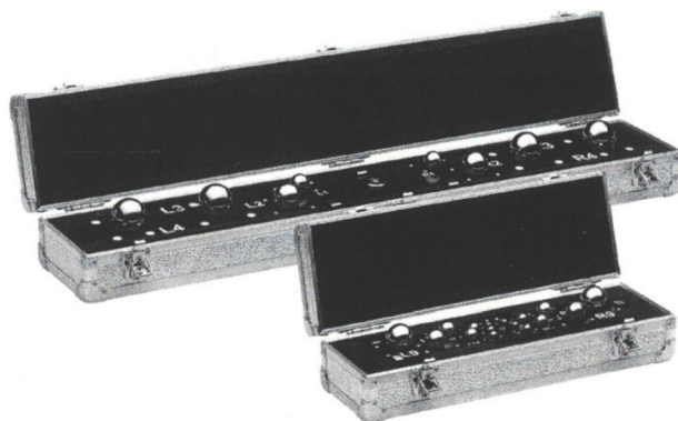
Obr. 26) Firmou GOM navržená zkušební tělesa pro kalibraci přístrojů ATOS (vpředu PSA400 s devíti páry koulí a vzadu PSA900 se čtyřmi páry koulí) [23]
