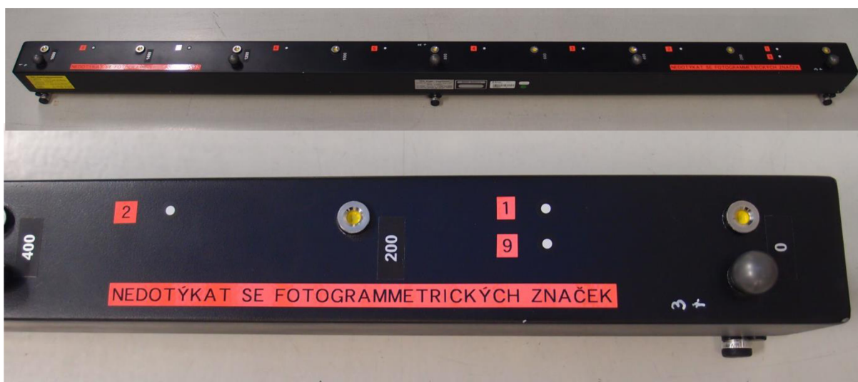
Obr. 32) Zkušební těleso typu scale bar s vylepenými referenčními body [25]
