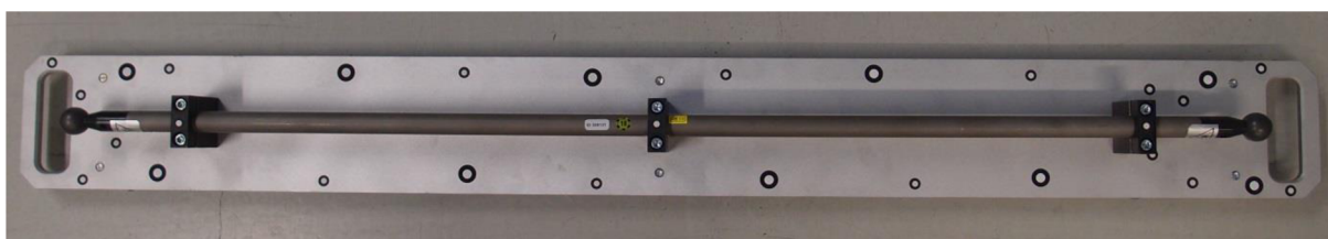
Obr. 29) Ball bar o délce 1000 mm [25]
