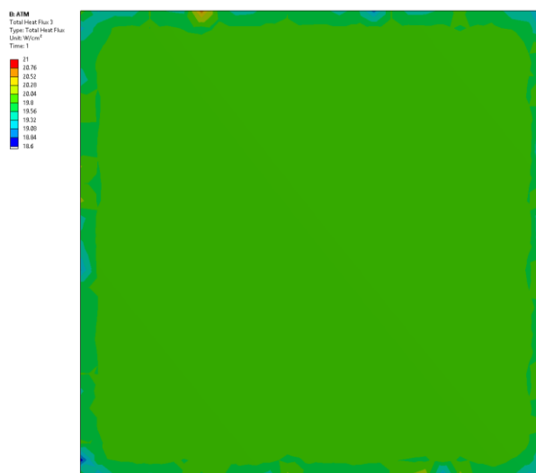
Obr. 39 Rozložení měrného tepelného toku po ploše měřeného modulu při simulaci měření při atmosférických podmínkách
