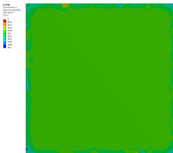
Obr. 39 Rozložení měrného tepelného toku po ploše měřeného modulu při simulaci měření při atmosférických podmínkách
