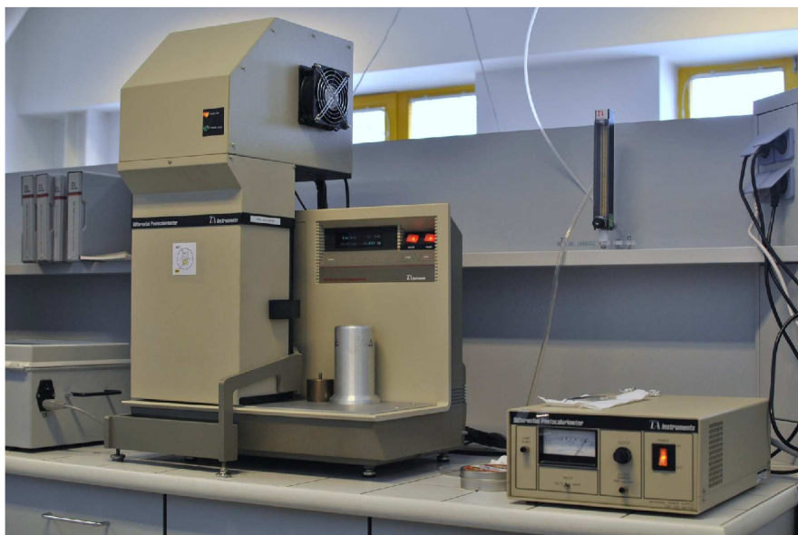
Obr. 17: Kalorimetr DSC 2920 (TA Instruments) vybavený příslušenstvím pro fotokalorimetrii Differential Photocalorimeter (TA Instruments)
