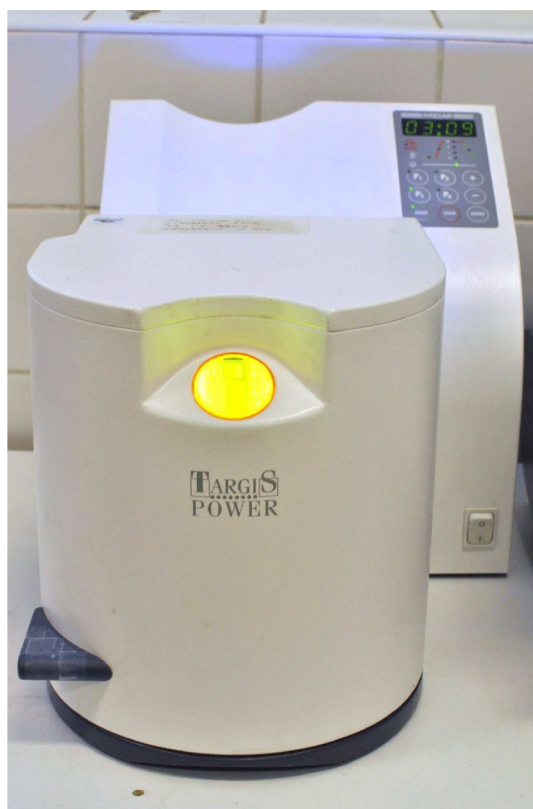
Obr. 15: Komora pro vytvrzování světlem Targis Power (Ivoclar, Lichněstějnsko)
