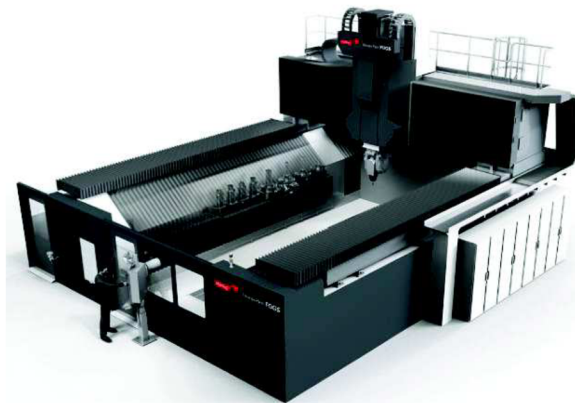
Obr. 2) Portálové obráběcí centrum - horní gantry [36]
