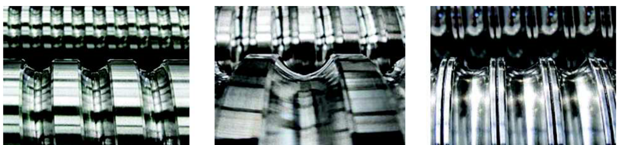
a) b) c) Obr. 9) Profily drážek kuličkových šroubů: a) broušený, b) okružovaný, c) válcový profil [22]
