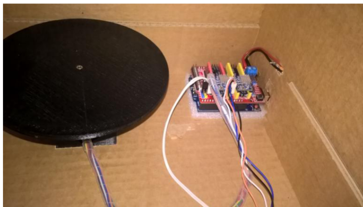
Obr. 8: Arduino UNO s CNC shieldem (v pravém rohu)
