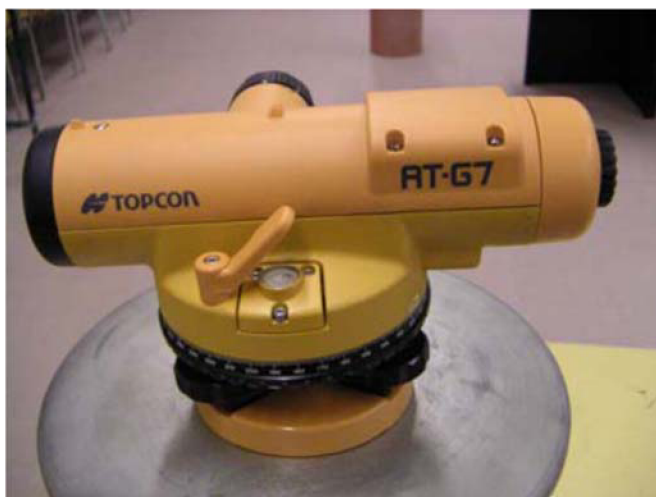
Obr. 10 – Nivelační přístroj TOPCON AT-G7 (Vondrák, 2004)
