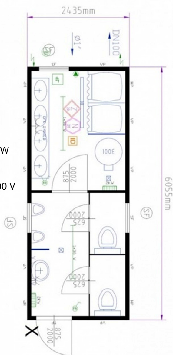
Obr. 17 Sanitární kontejner – půdorys [4]
