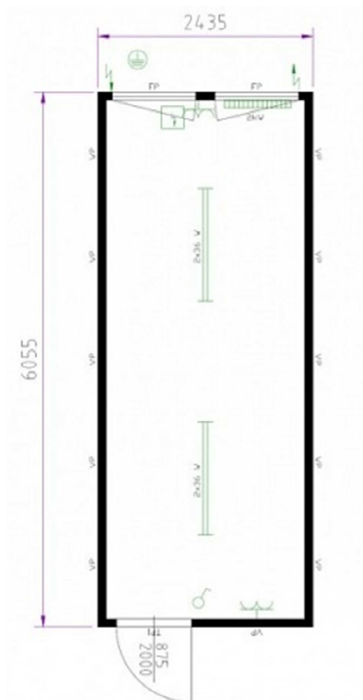
Obr. 15 Kancelářský kontejner – půdorys [3]
