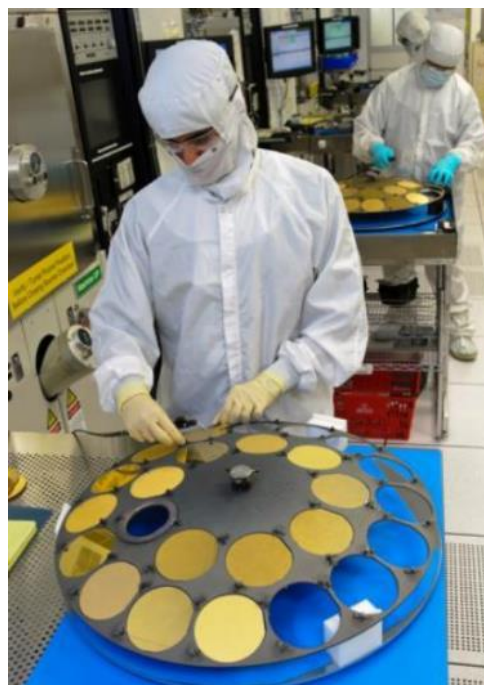
Obr. 13 Wafery po napařování tenkých vrstev – budoucích zlatých kontaktů [13]
