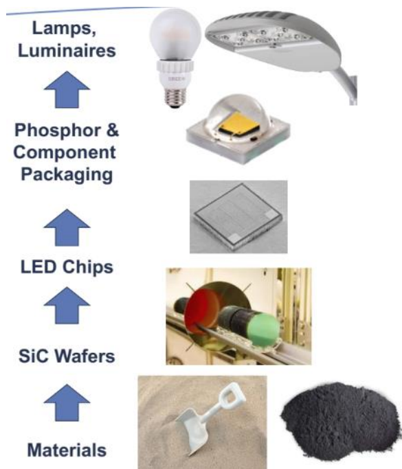
Obr. 12 Zjednodušené schema výroby LED (Cree) [13]
