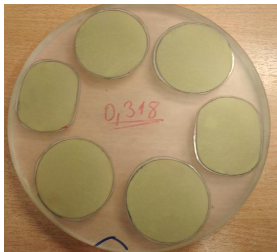
Obr. 22 Wafery připravené na broušení na tmelce
