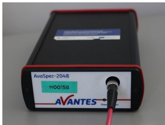
Obr. 32 Spektrometr Avantes AvaSpec-2048
