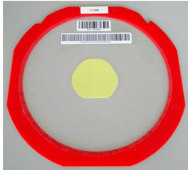
Obr. 24 Rozřezaný wafer nalepený na folii ve speciálním rámečku
