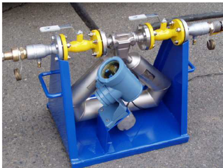
Obrázek 7: Příklad využití Coriolisova průtokoměru v čerpací stanici LPG [11]
