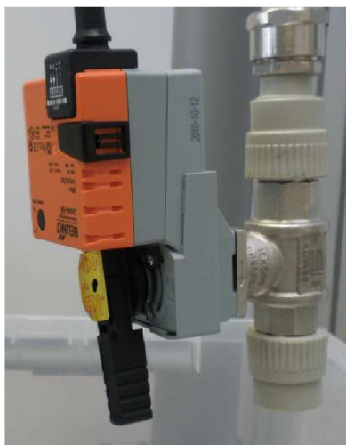
Obrázek 20: Regulační ventil R219 s pohonem LR24A-SR (Belimo)
