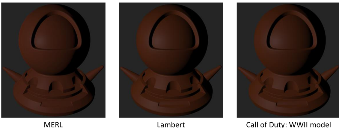
Obr. 26 Porovnání MERL materiálu red-plastic s dvěma difusními modely. Vlastní tvorba.
