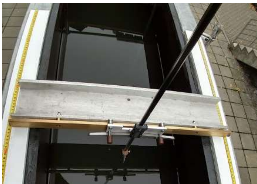
Obr. 33: Použité posuvné měřidlo pro měření výšky hladiny
