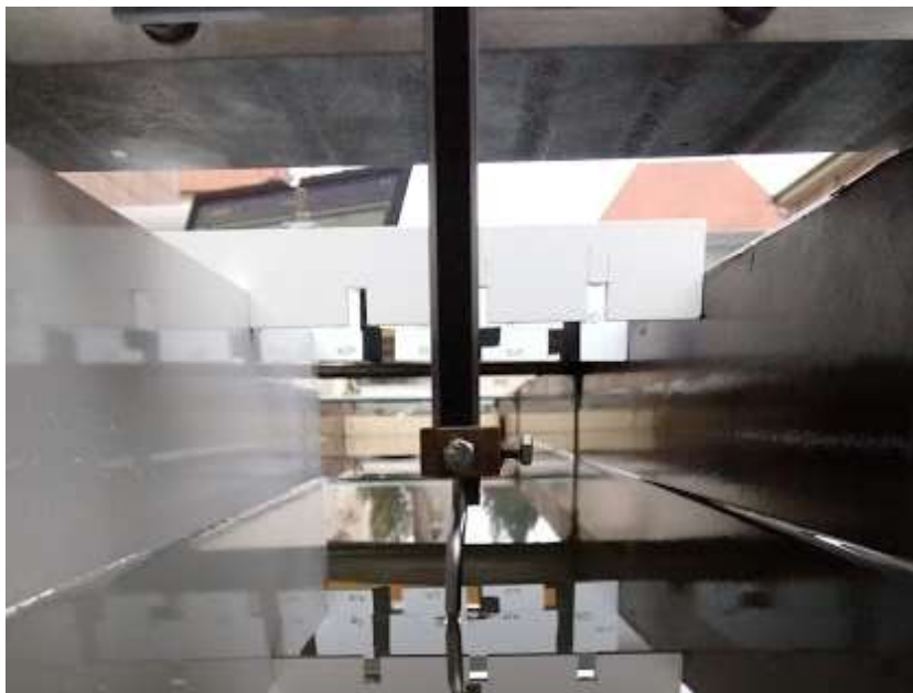
Obr. 34: Uchycení hrotu na posuvném měřidle
