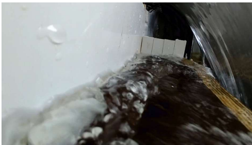
Obr. 46: Přepad neovlivněný konstrukcí přelivu
