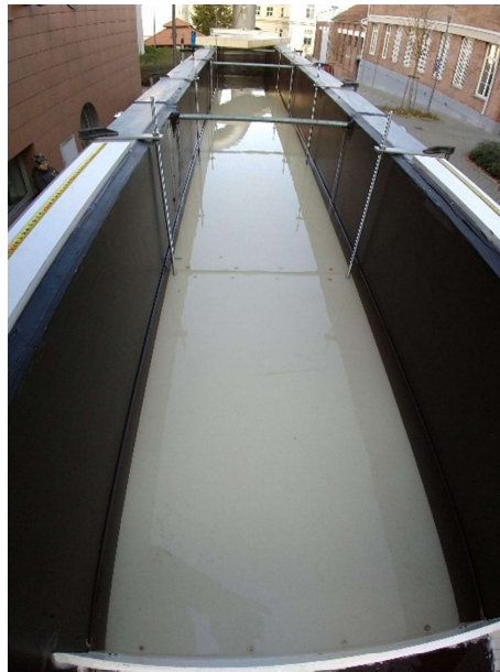
Obr. 29: Upevnění falešného dna
