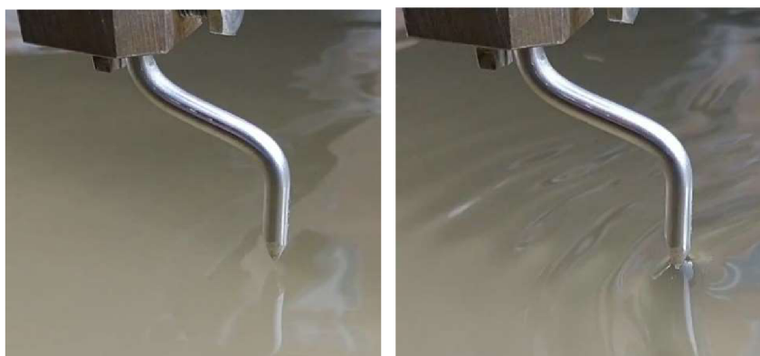
Obrázek 43: Hrot se nedotýká hladiny
