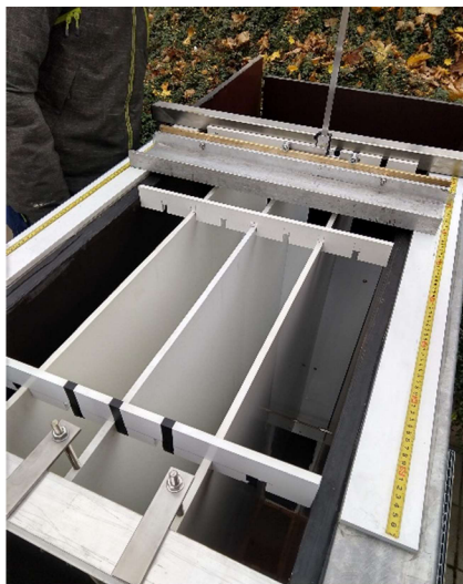
Obr. 27: Systém dělicích desek
