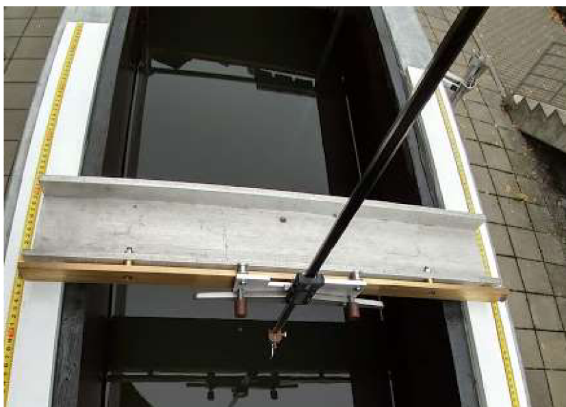
Obr. 33: Použité posuvné měřidlo pro měření výšky hladiny
