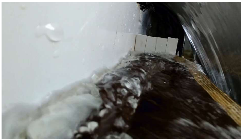
Obr. 46: Přepad neovlivněný konstrukcí přelivu
